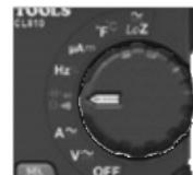
**NOTA:** cuando el multímetro está en la posición de Resistencia y los cables de prueba están en circuito abierto (no conectados a través de un resistor), o cuando se está probando un resistor averiado, aparecerá en la pantalla la leyenda "OL" (Sobrecarga). Esto es normal.
