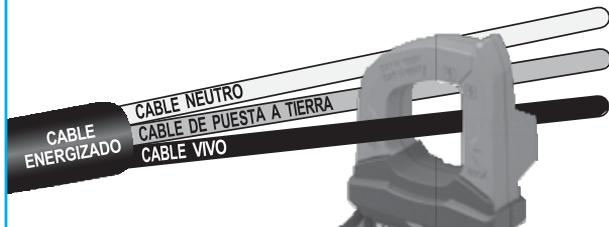
**NOTA:** la medición de corriente se puede hacer colocando las pinzas alrededor de conductores simples, pero no en cables que tengan alambres neutros y energizados. Para estos casos se necesita un divisor de línea; se recomienda el Cat. n.º 69409 de Klein.
