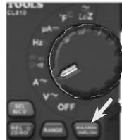
**NOTA:** mientras está en el modo corriente CA, la corriente de inserción es la medición predeterminada al presionar el botón "MAX/MIN/INRUSH" (Máximo/Mínimo/Corriente de inserción) ⑧. En los demás modos, Máx./Mín. es la medición predeterminada.
