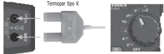
**⚠ Retire el termopar antes de configurar el multímetro en otras funciones de medición.**
